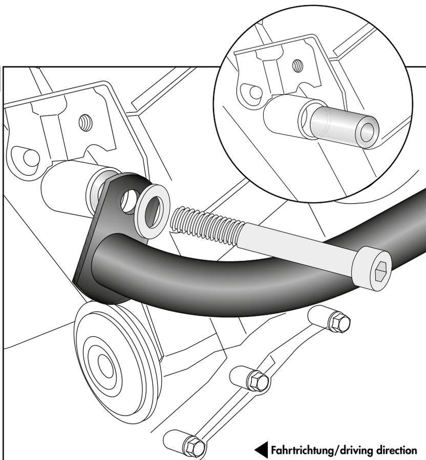
**Montage des Motorschutzbügel links hinten:**
