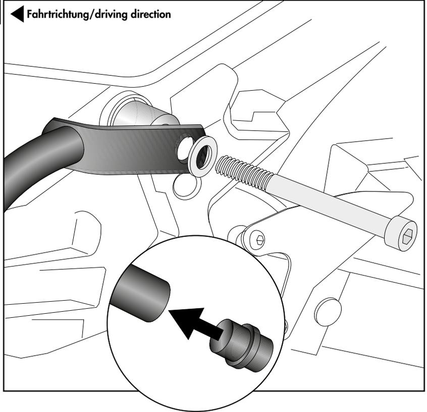
Verbindungsstück Ø25 in das Rohrende des Motorschutzbügels fügen.
