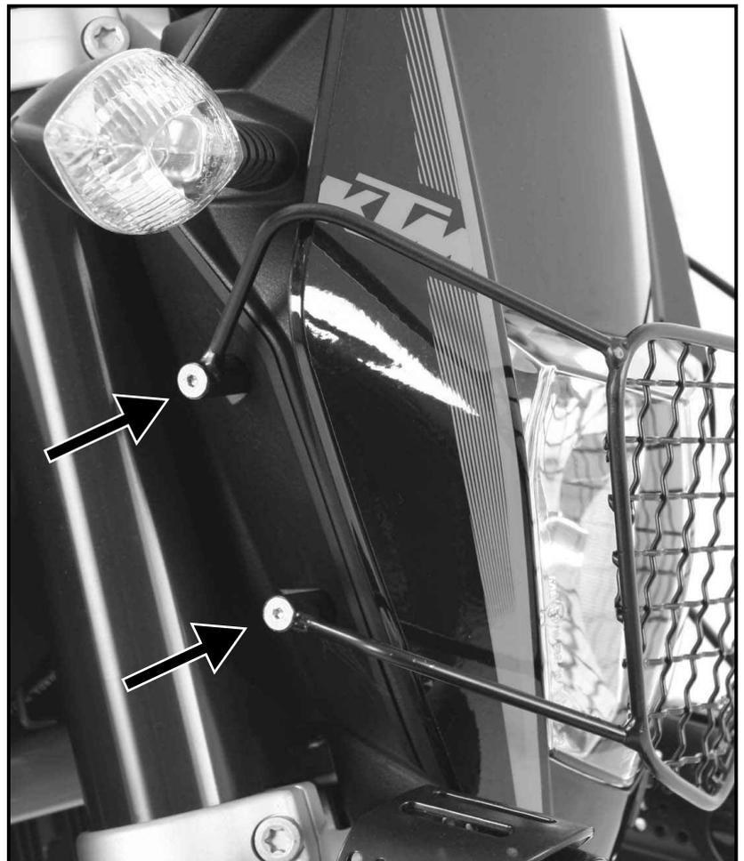
Die Originalschrauben der Maskenbefestigung herausdrehen - sie entfallen. Das Lampenschutzgitter von unten nach oben positionieren, und mit den Senkinbusschrauben M5x45 montieren. Gitter ausrichten und festziehen.
