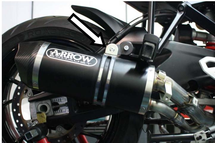
**IT** · Fissare il terminale alla staffa mediante fascetta di sostegno
