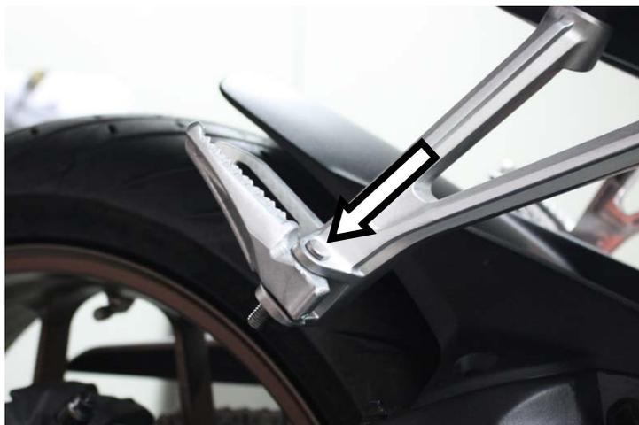
**IT** · Sostituire il perno del pedolino con quello fornito
