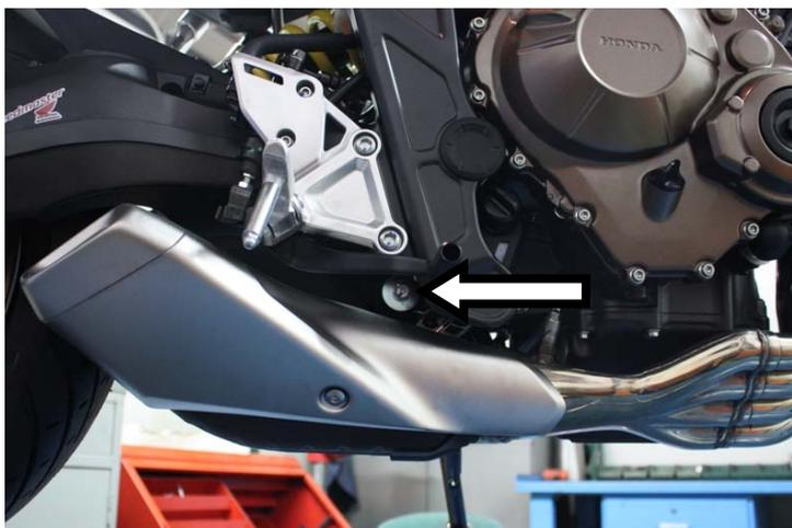
**IT** · Svitare la vite indicata e rimuovere lo scarico originale dalla moto (fare attenzione al cavo della sonda lambda)
