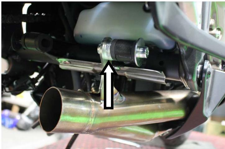
**IT** · Serrare senza stringere completamente l'attacco del raggruppamento al telaio interponendo lo spessore fornito (solo per versione con puntalino)
