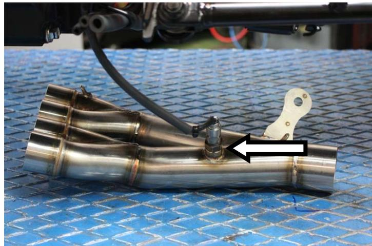
**IT** · Avvitare la sonda lambda nell'attacco del raggruppamento
