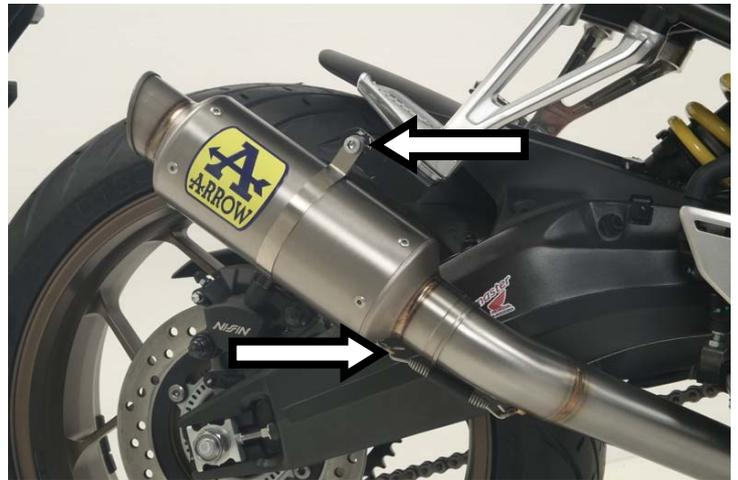
**IT** · Innestare il terminale GP2, serrarlo alla staffa mediante fascetta ed ancorare la molla
