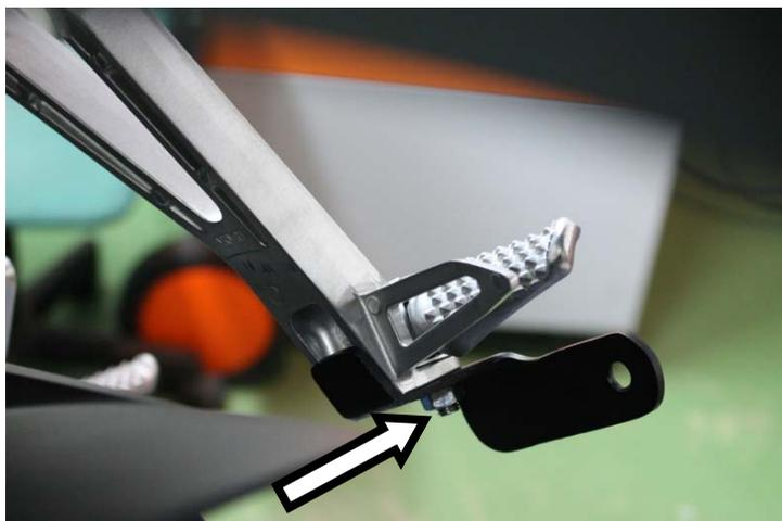
**IT** · Fissare nel perno la staffa di sostegno terminale
