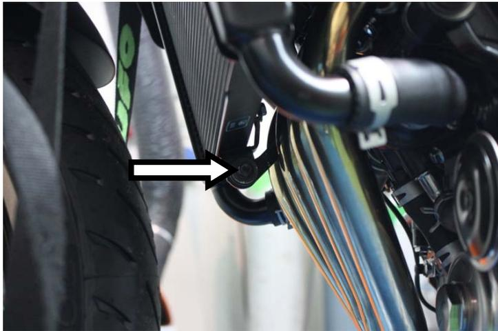
**IT** · Svitare la vite inferiore di fissaggio radiatore
