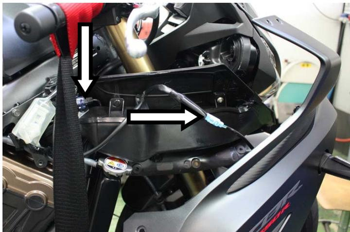
**IT** · Disconnettere il cablaggio della freccia e rimuovere la carena laterale DX
