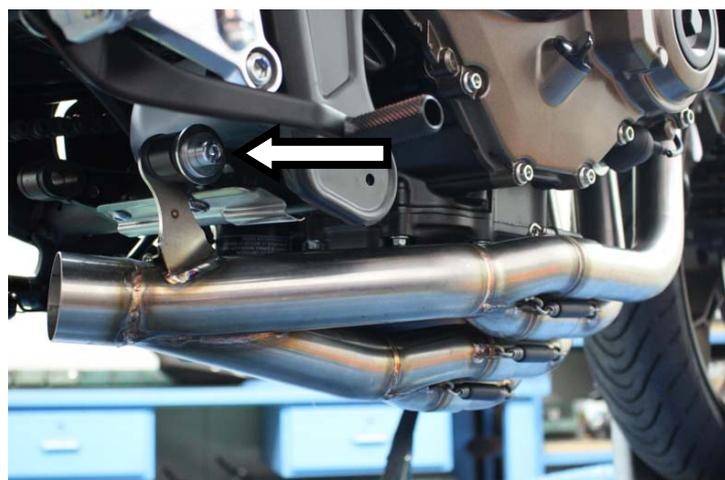
**IT** · Serrare senza stringere completamente l'attacco del raggruppamento al telaio
