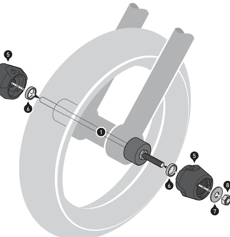
Montieren Sie die Sturzpzds (5) mit den Muttern (8) **beidseitig** an der Gewindestange (1).
