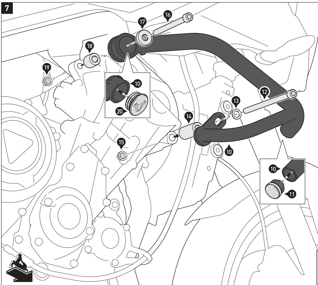
Setzen Sie den Kunststoffstopfen (11) in den Sturzbügel (10) ein.
