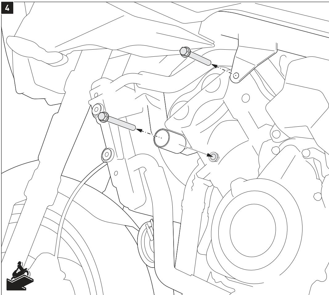
**⚠️ WARENUNG:** Beginnen Sie mit der Montage des rechten Sturzbügels erst, wenn Sie die Montage des linken Sturzbügels abgeschlossen haben!
