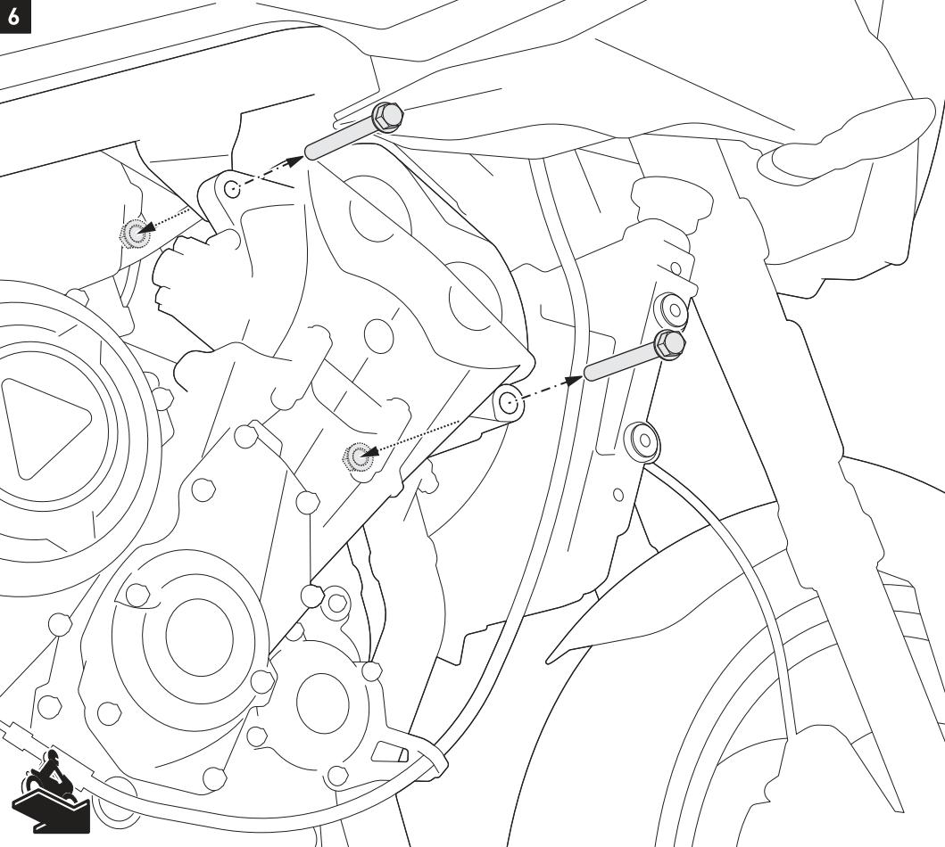
Entfernen Sie die original Motorhalteschrauben und Muttern auf der **rechten** Fahrzeugsseite.
