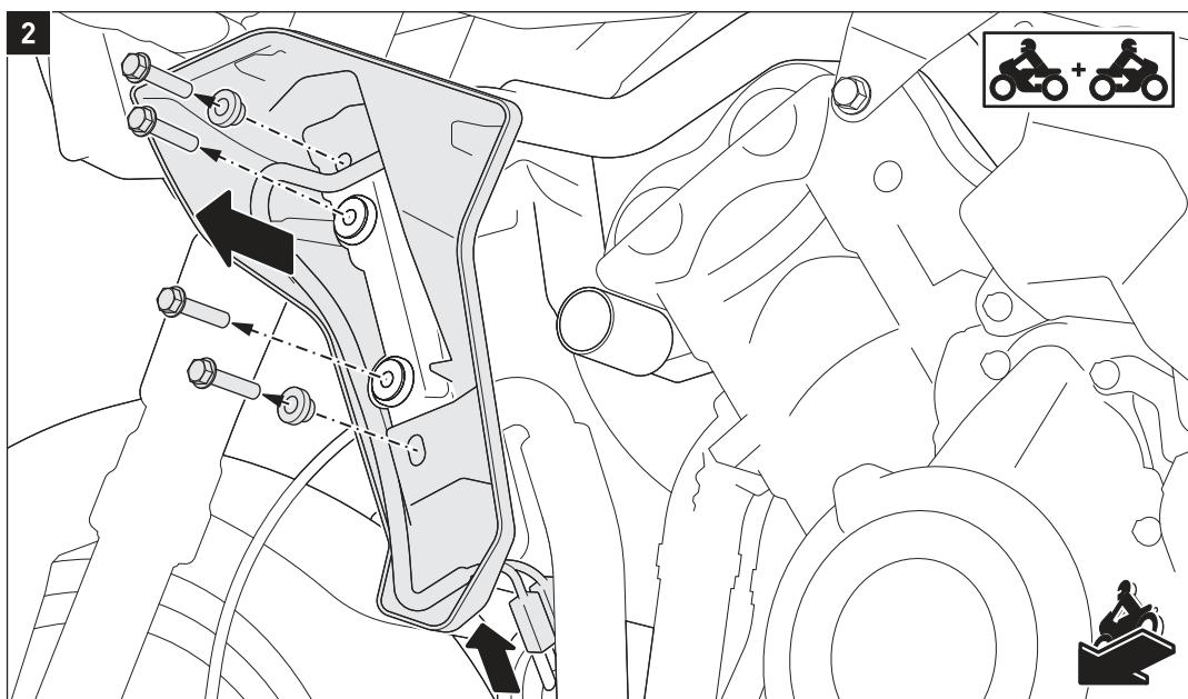
Lösen Sie die Stecker der Hupe auf der **linken** Fahrzeugseite.
