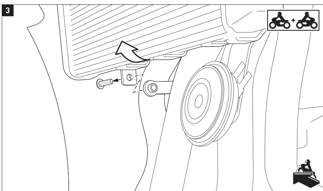
Lösen Sie die gezeigte Schraube und drücken Sie den Kühlerrahmen ein paar Grad in Fahrtrichtung vom Fahrzeug weg.
