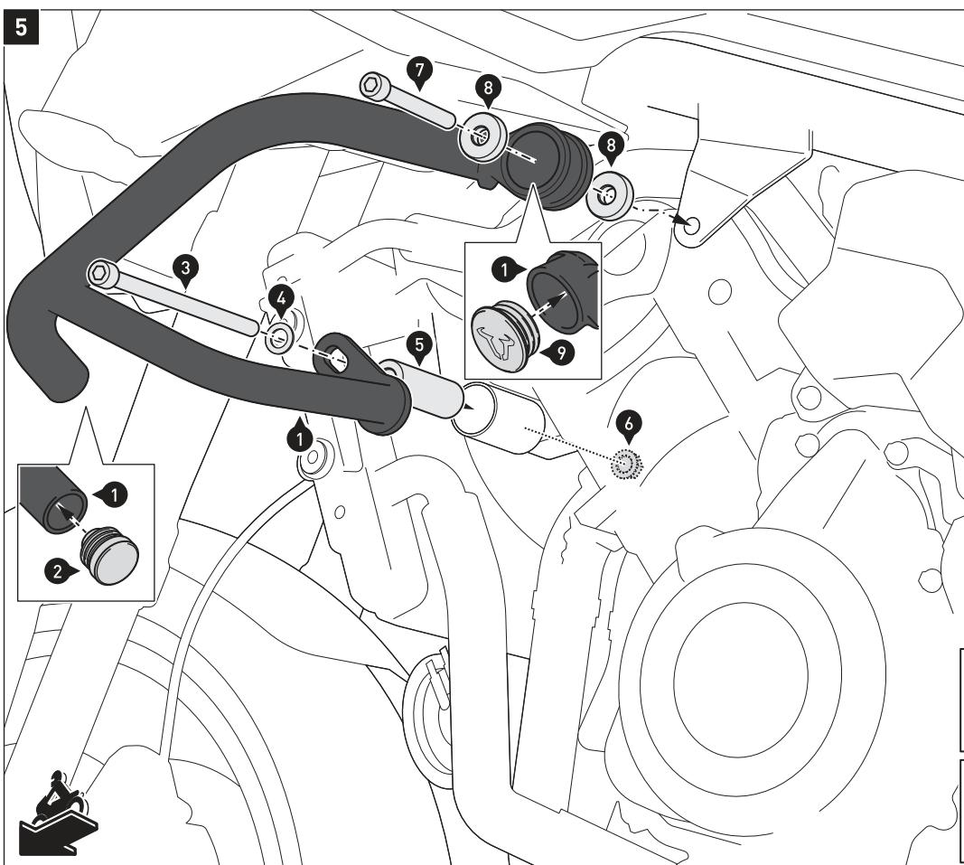
Setzen Sie den Kunststoffstopfen (2) in den Sturzbügel (1) ein.
