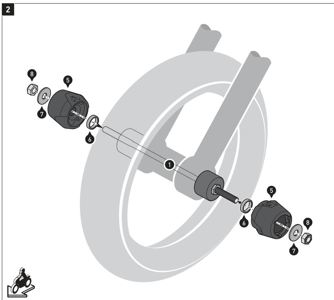
Montieren Sie die Sturzpzds (5) mit den Muttern (8) **beidseitig** an der Gewindestange (1).
