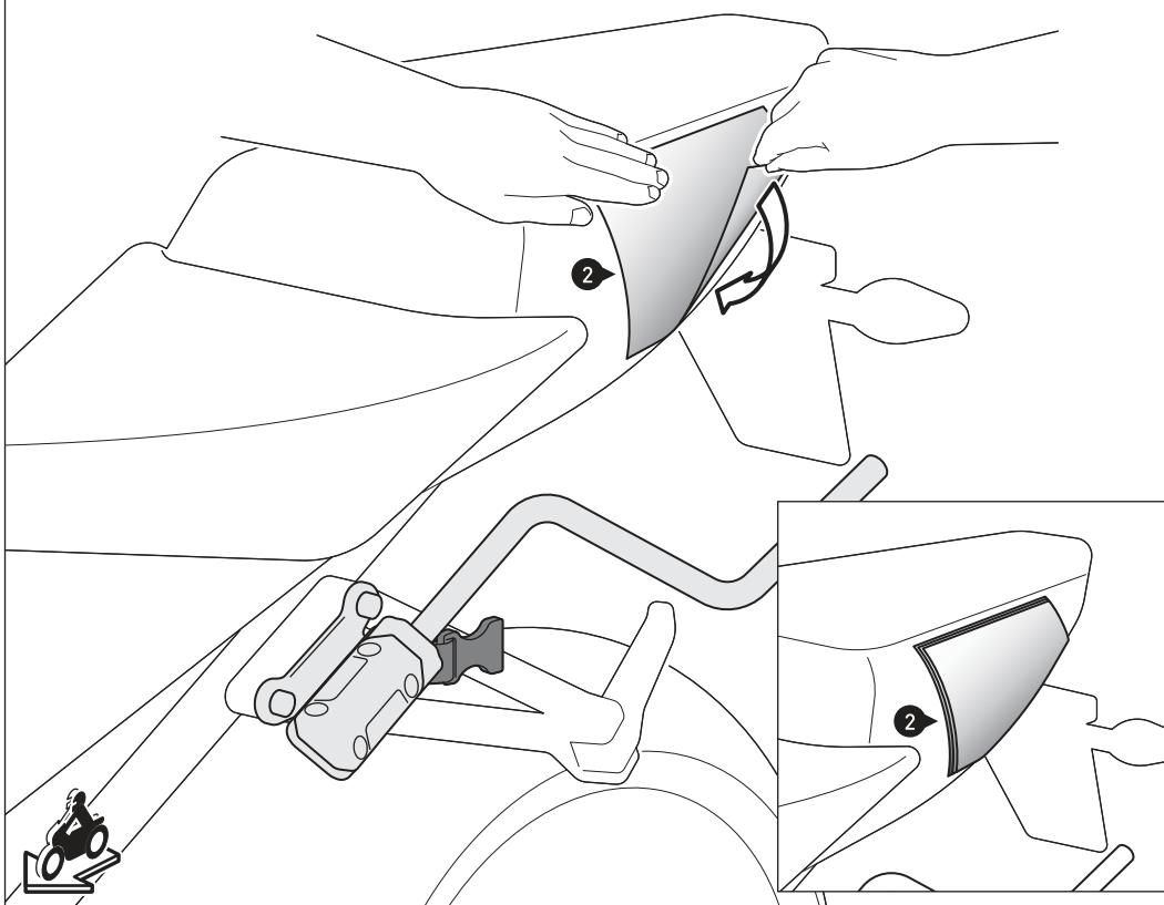
**ES** - Tras montar la estructura de las alforjas, se debe proteger la superficie de la motocicleta de posibles ralladuras con las lámina protectora que se incluye (2). Limpie la grasa y suciedad de la superficie antes de aplicar la película protectora.
