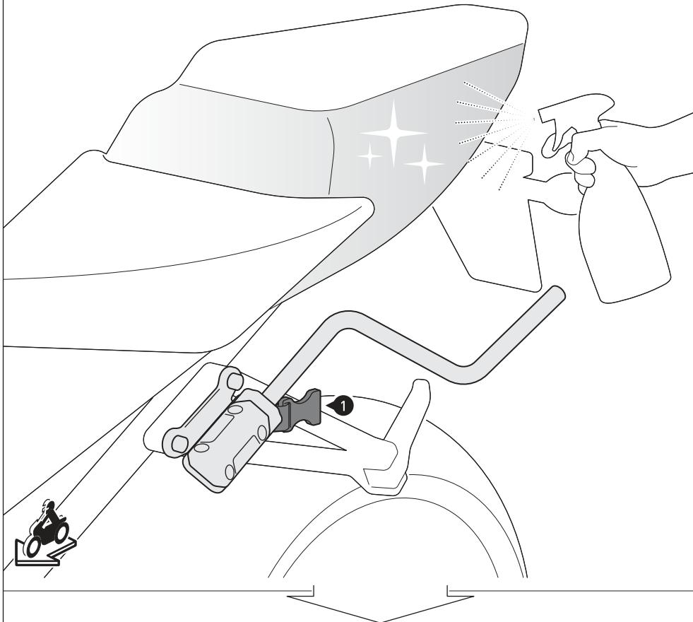
**DE** - Nachdem Sie die Abstandsbügel an Ihrem Fahrzeug montiert haben, müssen Sie die Auflageflächen der Satteltaschen mit der beigepackten Lackschutzfolie (2) bekleben, um Beschädigungen zu vermeiden. Reinigen Sie die zu beklebende Fläche vor dem Aufbringen der Lackschutzfolie gründlich von Fett- und Schmutzrückständen.
