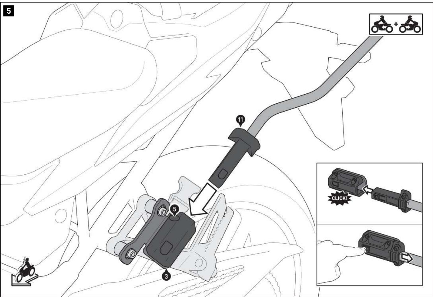
Inserte los conectores (11)/(12) en los soportes de los conectores (3) a ambos lados.
