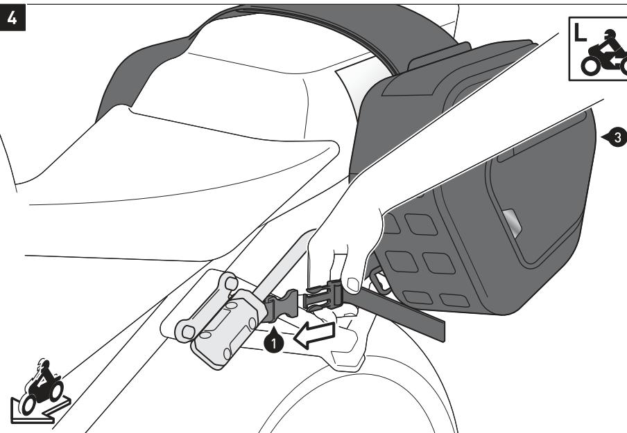
**ACHTUNG:** Beachten Sie unbedingt die den Satteltaschen Abstandsbügeln beiliegende Anbauanleitung! Rasten Sie nun die Sicherungsgurte der Satteltaschen [3] **beidseitig** in die zuvor lose verschraubten Klickverschlüsse [1] ein. Ziehen Sie jetzt die Schrauben der Klickverschlüsse [1] an, wie in der Anbauanleitung der Satteltaschen Abstandsbügel beschrieben.
