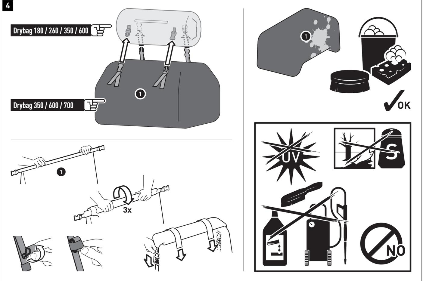
Las bolsas traseras están diseñadas para fijarse a otras bolsas traseras de la serie Drybag. Conecte las bolsas traseras con las hebillas (**máx. DOS bolsas traseras apiladas una encima de la otra por vehículo, y la bolsa INFERIOR debe ser más grande que la bolsa SUPERIOR**). A continuación, verifique que todas las hebillas estén correctamente colocadas y bien sujetas.
