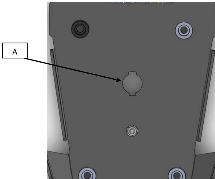
3) Fissare il faro posteriore LED di serie DUCATI MONSTER 696 sul lembo (A) presente sul particolare ESTR-0805-S1, utilizzando le viti autofilettanti di serie.
