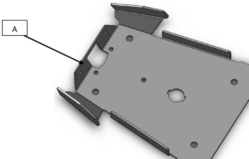
4) Se le due coppie di boccole non risultano già innestate nella placca in Al ESTR-0805-S1, montarle nei 4 fori da 10mm presenti sulla placca ESTR-0806-S1, forzandole a pressione in modo che siano rigide con la placca, in modo da facilitare le operazioni successive di montaggio. Aiutarsi con un martello in gomma, posizionando la placca ESTR-0806-S1 su una superficie che eviti lo scalfirsi dell'ossidazione durante l'innesto delle boccole.
