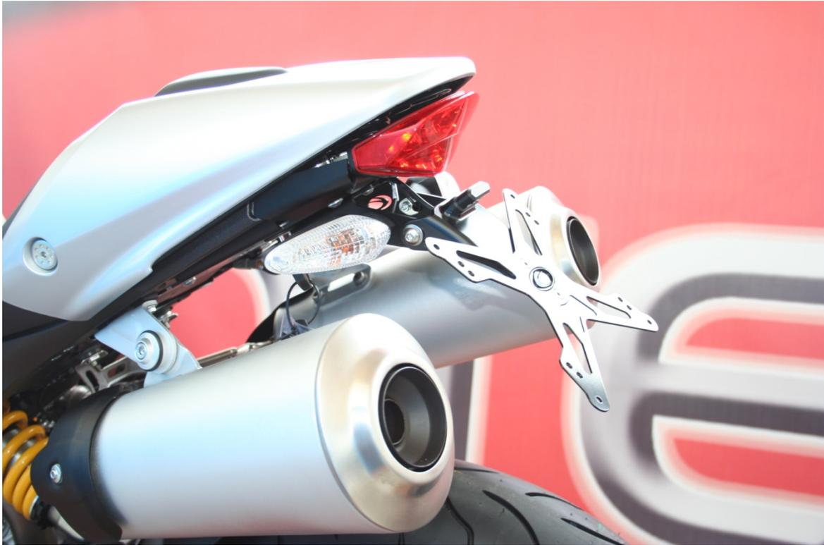
Posizionato il tutto in linea con le 4 bocche filettate elastiche di serie, utilizzare le 4 viti in Ergal TCBEI M6x20 fornite nel KIT per fissare il tutto al telaio.
