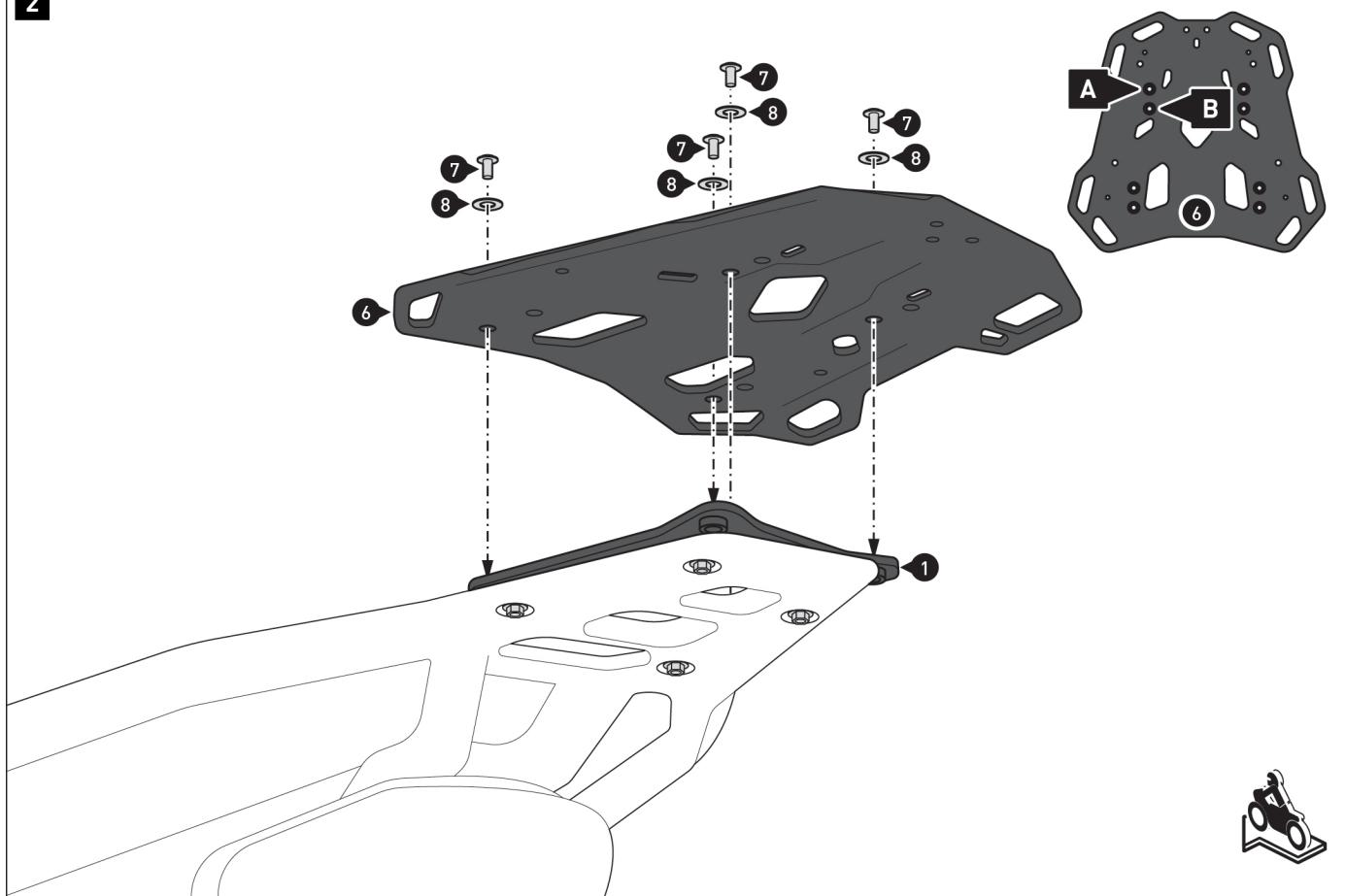
**⚠ NOTA:** Dependiendo del espacio disponible, atornille el portaequipaje (6) en la posición de montaje marcada **(A)** o **(B)**, tal y como se muestra en el dibujo de detalle.
