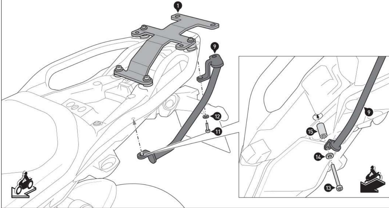
Atornille los puntales de fijación (9/10) por **ambos lados** a la placa de fijación (1) y al vehículo.
