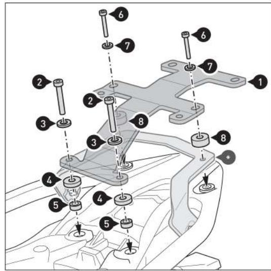
**⚠ NOTA:** Si se instala al mismo tiempo que el soporte lateral de SW-MOTECH (\*), atornille las piezas como se muestra en el dibujo de detalle. En ese caso, no necesitará los espaciadores (4). En su lugar, monte la placa de fijación (\*) incluida con el soporte lateral.
