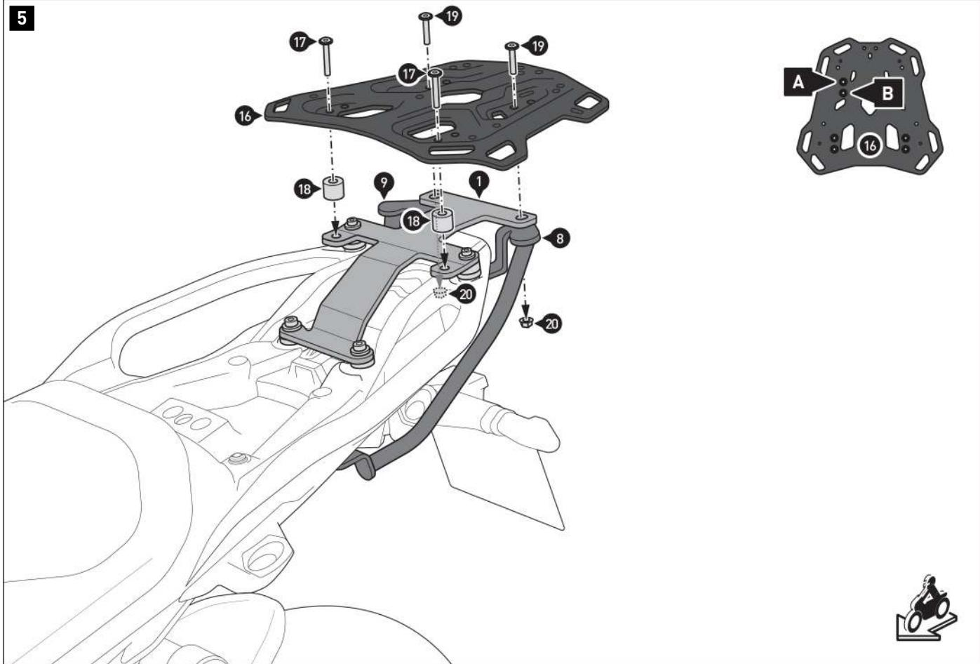
**⚠ NOTA:** Dependiendo del espacio disponible, atornille el portaequipaje (16) a la posición de montaje marcada con una **[A]** o una **[B]**, tal y como se muestra en el dibujo de detalle.
