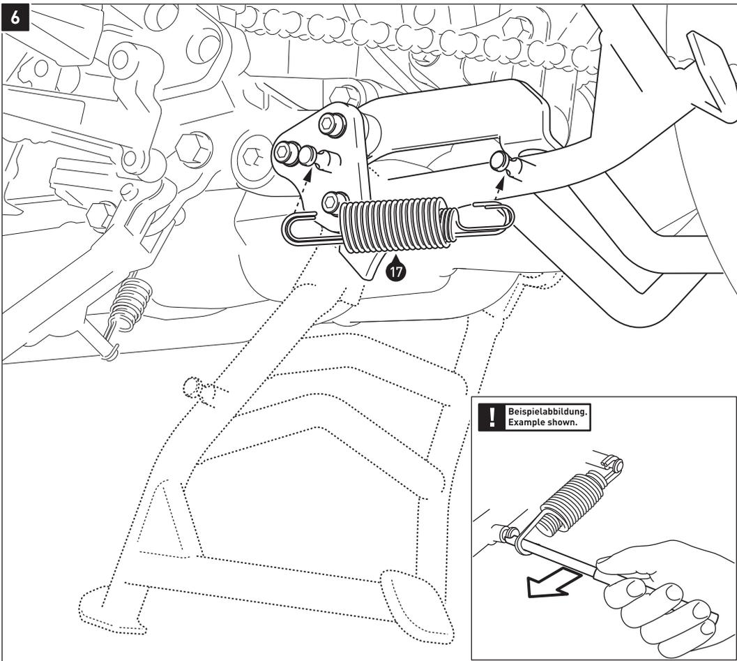
Klappen Sie den Hauptständer (1) vollständig nach oben. Benutzen Sie einen geeigneten Heber, um ihn in Position zu halten. Hängen Sie nun den Zugfedersatz (17) mit einem geeigneten Werkzeug\* ein, wie in der Zeichnung gezeigt.
