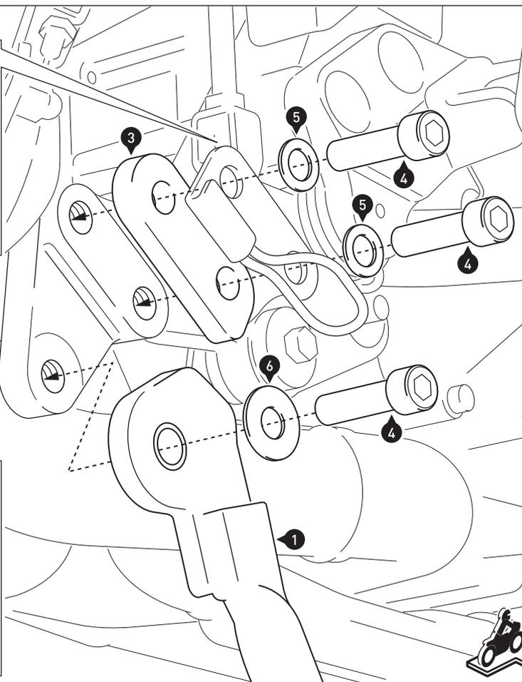
Verschrauben Sie das Anschlagblech (3) mit dem original Halteblech am Fahrzeugrahmen, wie in der Zeichnung gezeigt.
