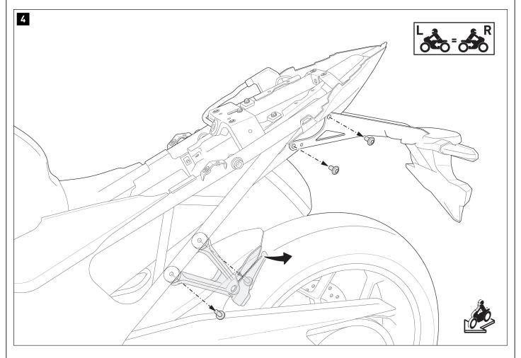
Afloje los tornillos originales y retire el soporte del reposapiés del pasajero del vehículo.
