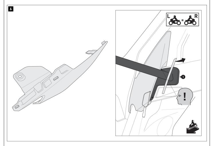
$\triangle$  **NOTA:** El revestimiento retirado en el paso [3] debe adaptarse al soporte lateral (1) para volver a montarlo.
