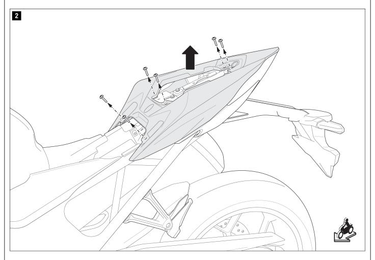
Afloje los tornillos originales y retire el revestimiento del vehículo.
