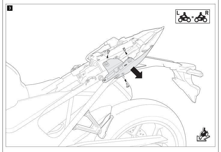
Afloje las clavijas del revestimiento original, desmonte el clip de plástico y retire el revestimiento del vehículo.
