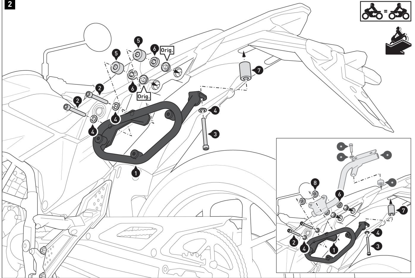
**⚠ NOTA:** El dibujo de detalle muestra la instalación del soporte lateral con el portaequipaje de SW-MOTECH. Utilice las piezas de montaje incluidas con el portaequipaje (•) junto con las que se indican para el soporte lateral.
