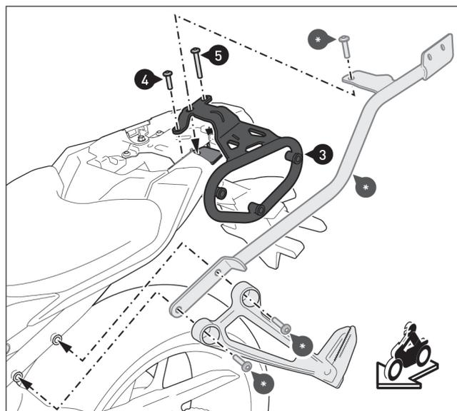
**⚠ NOTA:** Si se instala al mismo tiempo que el portaequipaje de SW-MOTECH (\*), atornille las piezas como se muestra en el dibujo de detalle. Los tornillos (6) y la arandela (7) ya no son necesarios. En su lugar, monte los tornillos (\*) incluidos con el portaequipaje.
