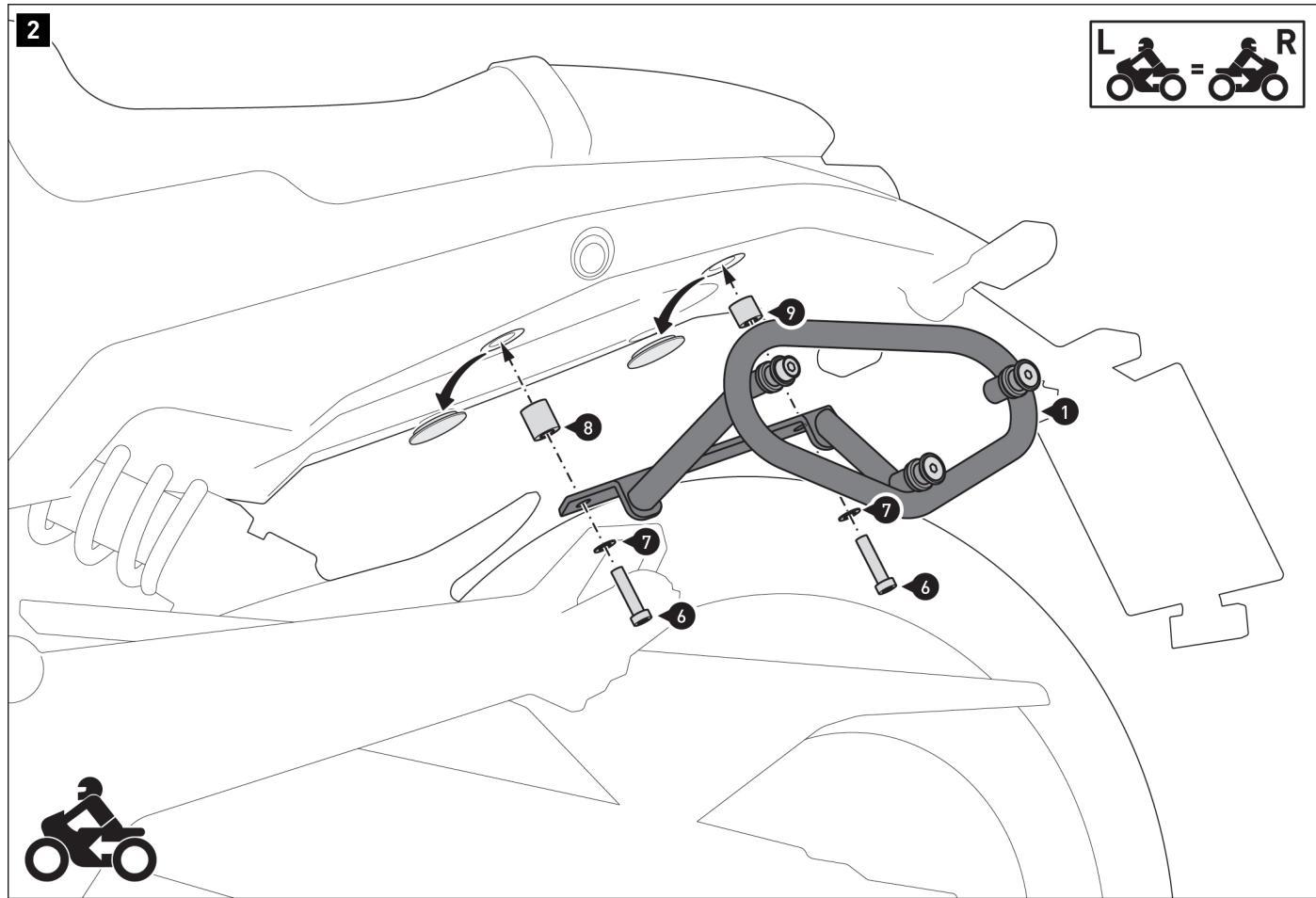
Retire los tapones de los puntos de montaje.
