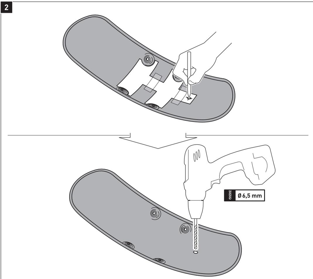
**HINWEIS:** Die Bohrung für den Schlauch-Clip ist eine Empfehlung.
