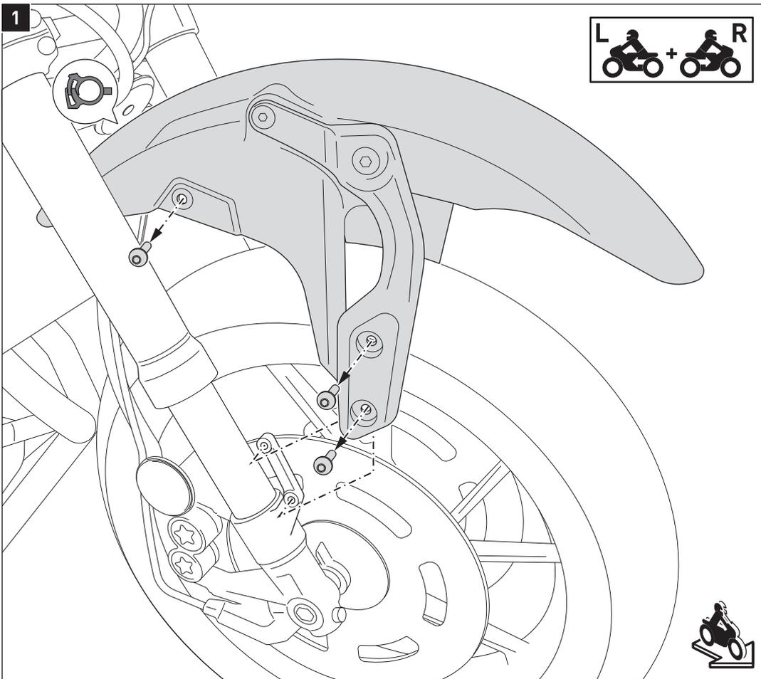
Lösen Sie den Schlauchclip und beidseitig die gezeigten Schrauben. Entfernen Sie dann den original Kotflügel vom Fahrzeug, wie in der Zeichnung gezeigt.
