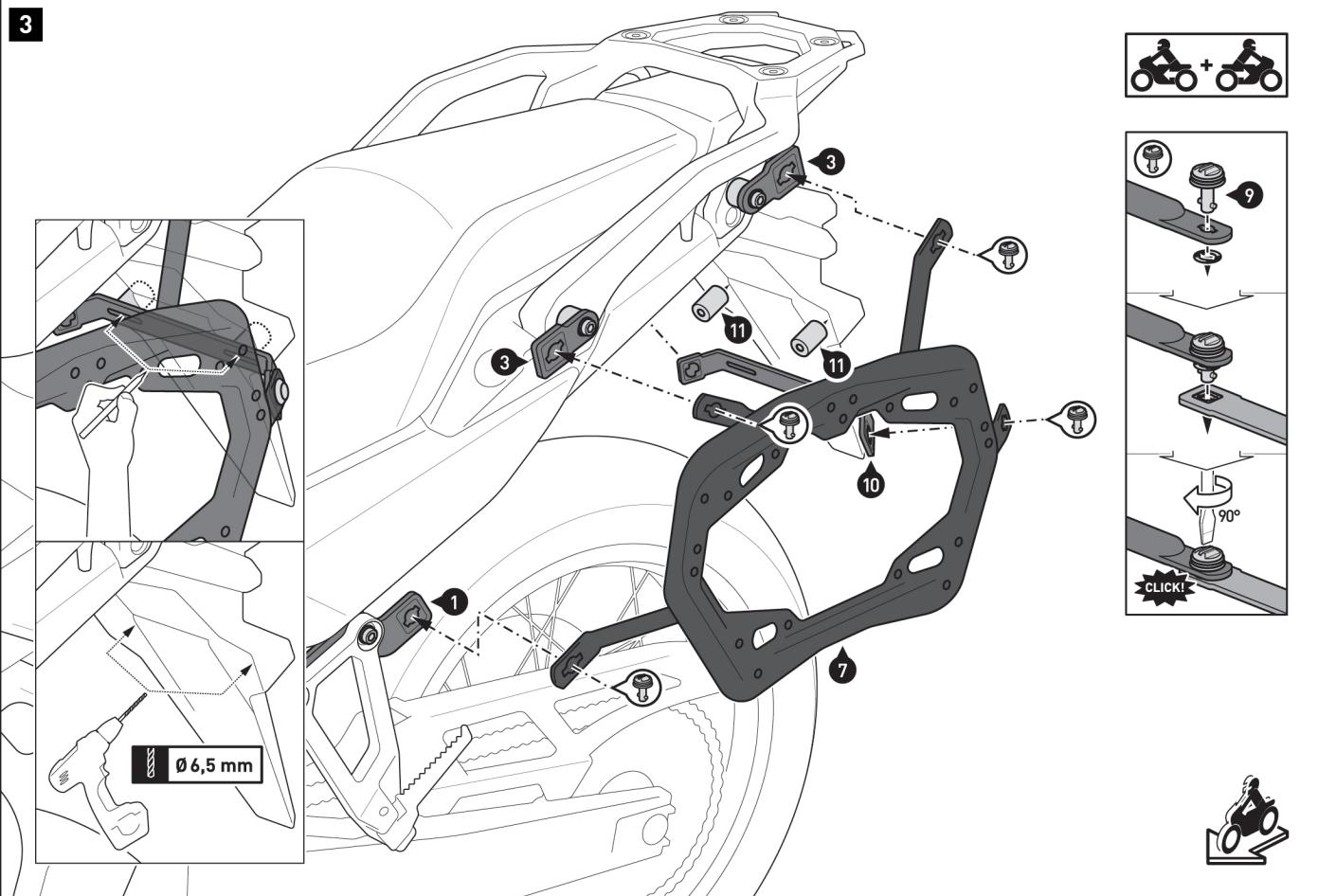
**⚠ NOTA:** Los pasos 3 y 4 son opcionales y solo se pueden seguir con el portamatrículas indicado. Si su vehículo tiene un portamatrículas diferente, la barra de unión (10) solo hay que fijarla entre los soportes laterales (7) y (8) con los cierres rápidos (9). En este caso, no necesario utilizar tornillos.
