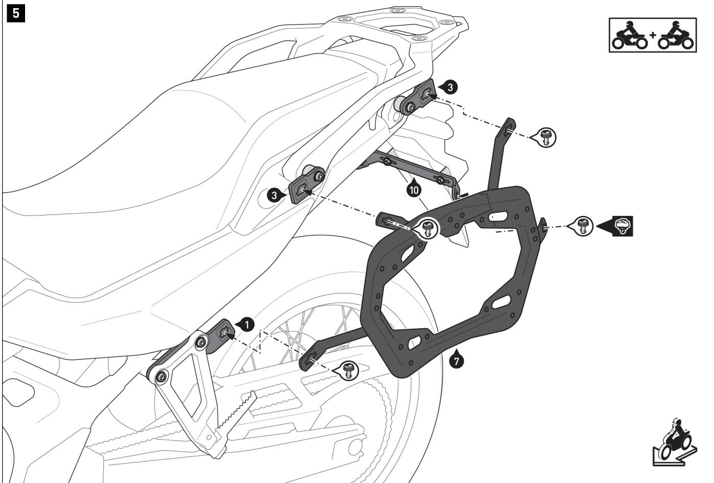
**⚠ NOTA:** Los sistemas antirrobo de SW-MOTECH están disponibles por separado; monte los sistemas antirrobo **a ambos lados** en la posición marcada.
