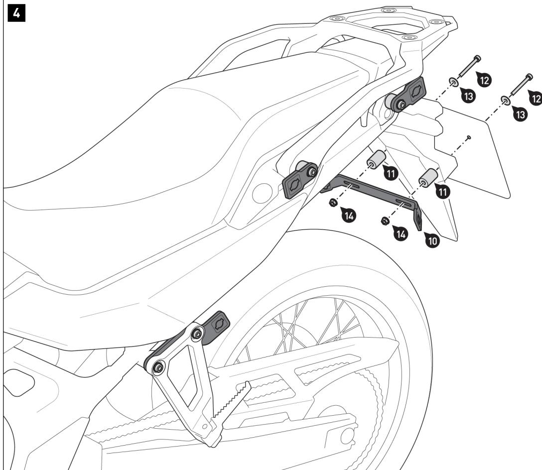
Atornille la barra de unión (10) a la matrícula en el portamatrículas.
