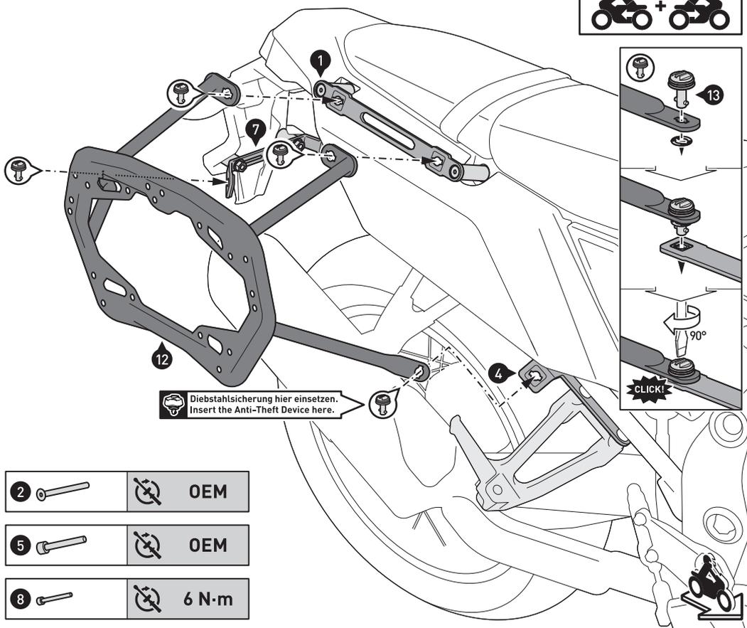
Verbinden Sie die Seitenträger (12) mit den Schnellverschlüssen (13) an den Befestigungslaschen (1) und (4) und dem Querverbinder (7), wie in der Zeichnung gezeigt. Sichern Sie die Schnellverschlüsse (13) mit den Sicherungsscheiben.
