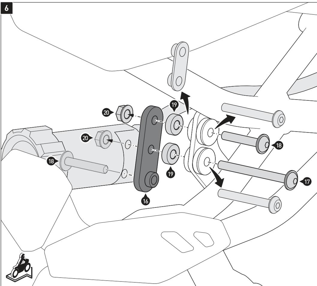
Entfernen Sie die original Verschraubplatte und die Schrauben des Federbeinverstellers.
