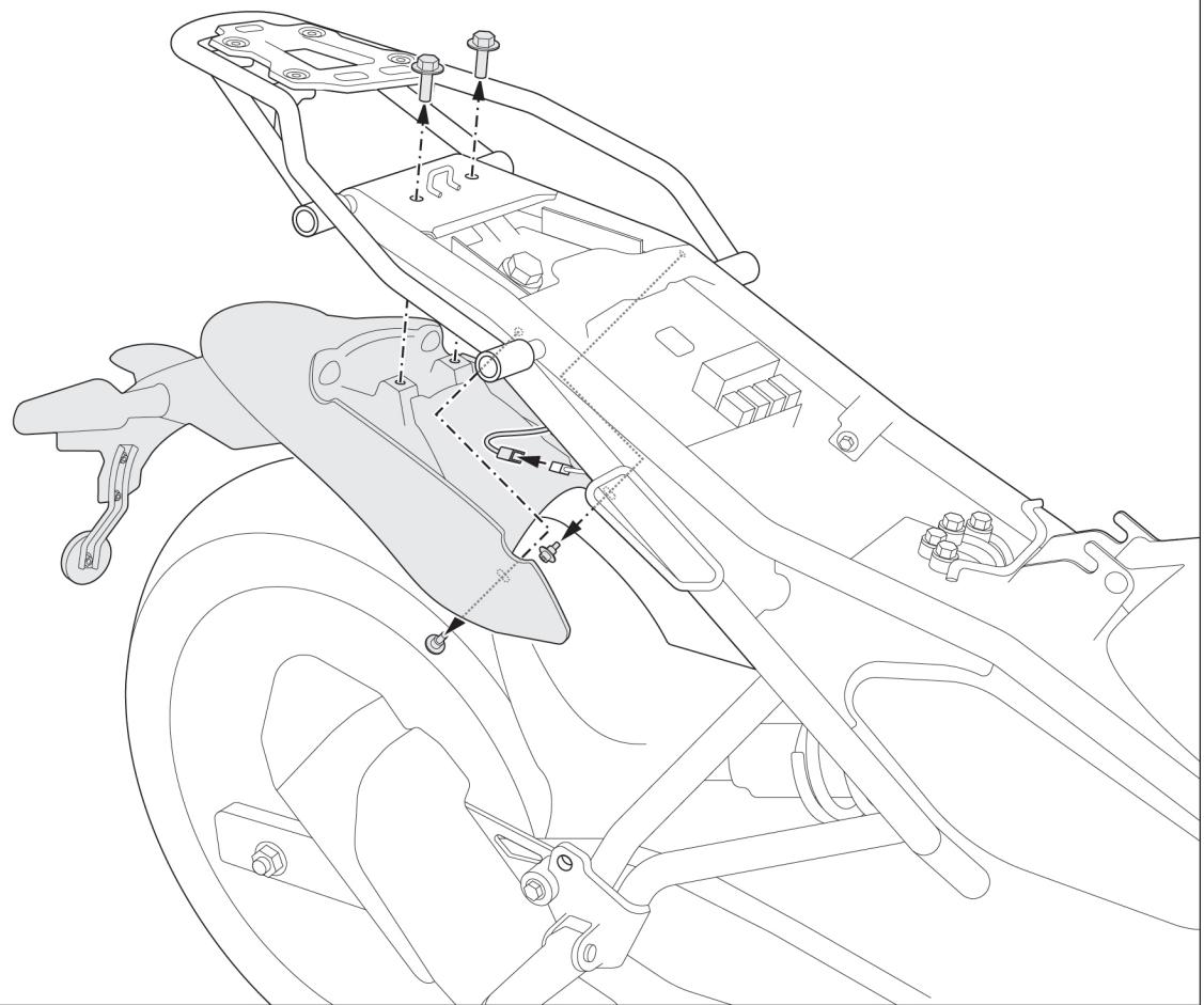
Afloje los cuatro tornillos del guardabarros; a continuación, afloje la conexión de enchufe del guardabarros.
