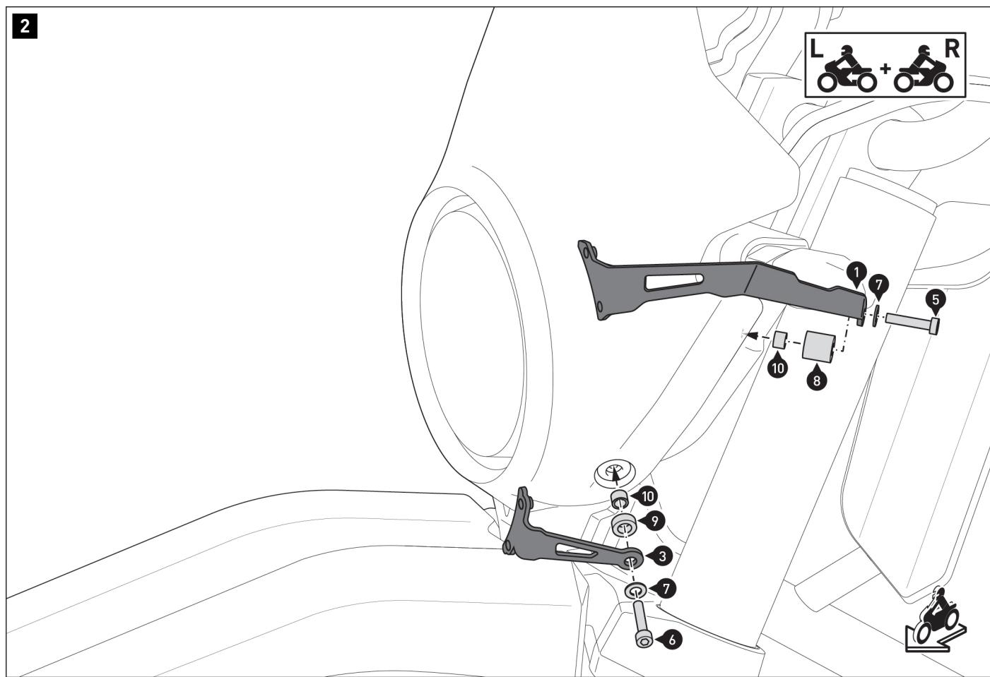
Atornille las placas de fijación (1/2) y (3/4) a **ambos lados** del vehículo.
