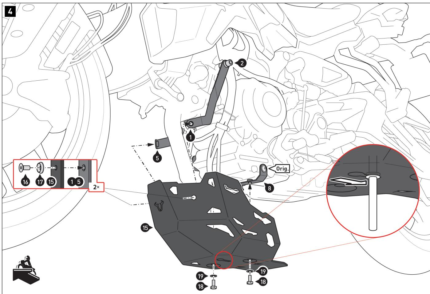
Conecte la manguera de desbordamiento con la arandela de goma a la abertura designada del protector de motor (15) (vea el dibujo de detalle de la derecha).
