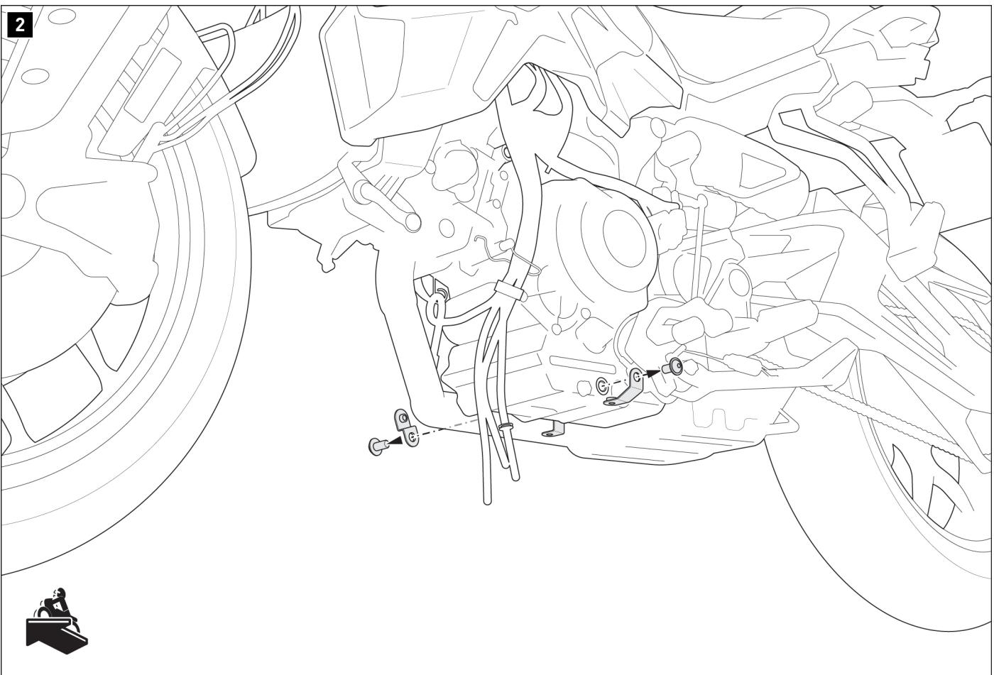
Afloje los tornillos originales que se muestran y luego retire las placas originales del protector de motor del vehículo.
