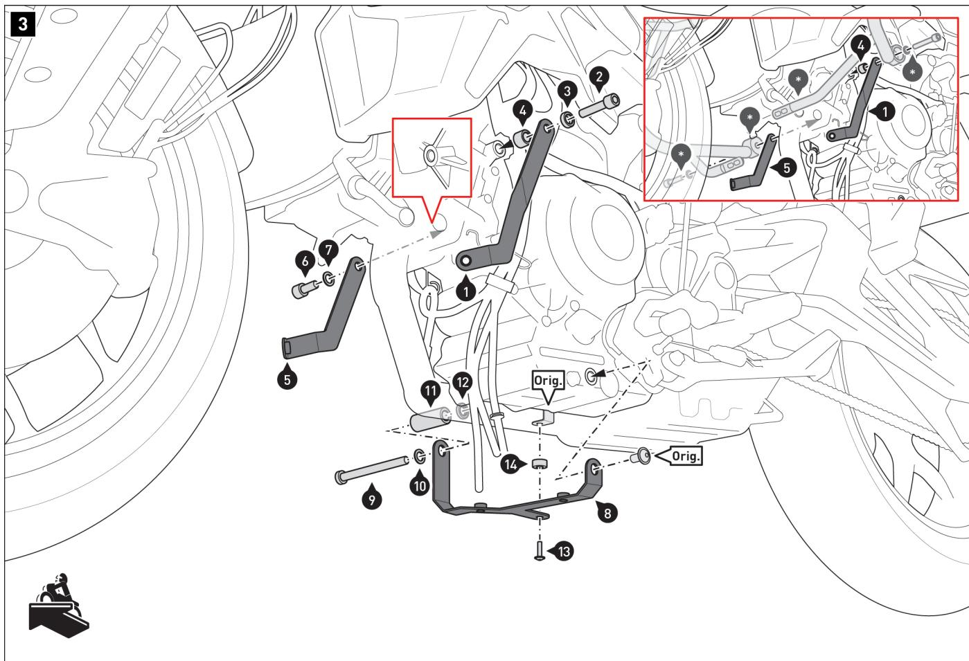
**NOTA:** El dibujo de detalle muestra la instalación del protector de motor con la protección lateral de motor de SW-MOTECH. Utilice las piezas de montaje (\*) incluidas con la protección lateral de motor junto con las piezas de montaje del protector de motor que se muestran.
