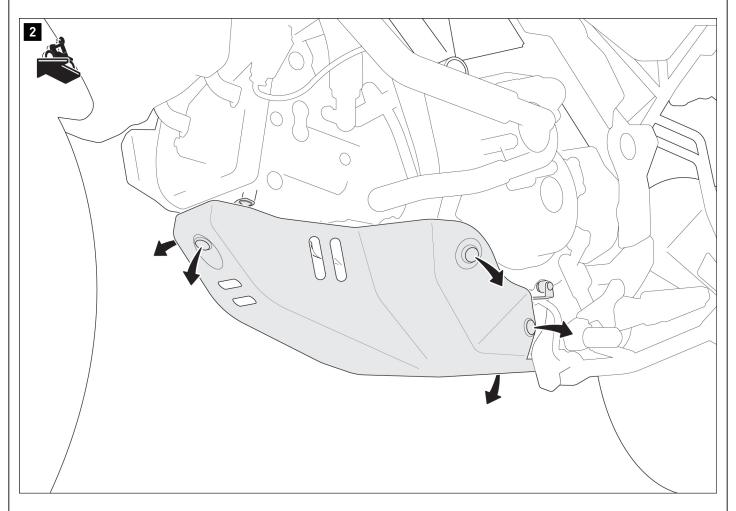
Afloje los tornillos indicados del protector de motor original. Retire el protector de motor del vehículo.
