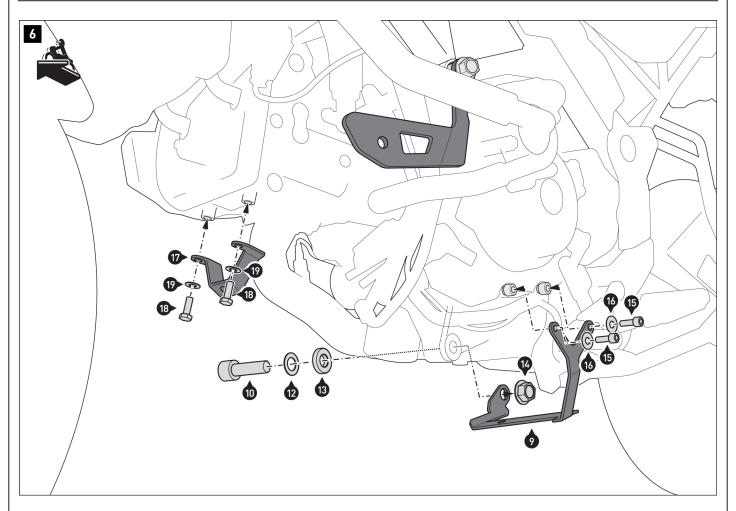
$\triangle$  **NOTA:** Al montar el caballete central de SW-MOTECH, coloque el tornillo (11) en el punto de fijación izquierdo. En lugar de usar las piezas (12) y (13), utilice las piezas del caballete central.
