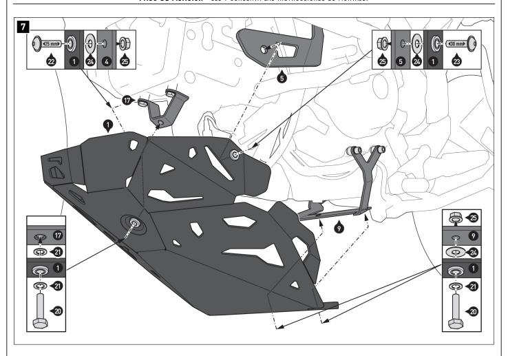
Atornille el protector de motor (1) a las placas de fijación (4), (5), (9) y (17). ADVERTENCIA: Utilice fija tornillos líquido solo para el tornillo frontal (20).
