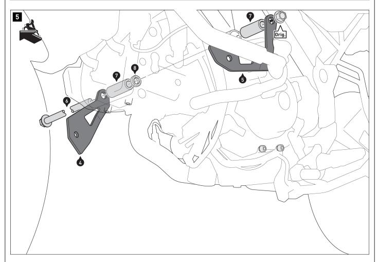
$\triangle$  **NOTA:** Utilice las piezas indicadas cuando monte las protecciones laterales del motor de SW-MOTECH. Las protecciones laterales van atornilladas a las placas de fijación (4) y (5).
