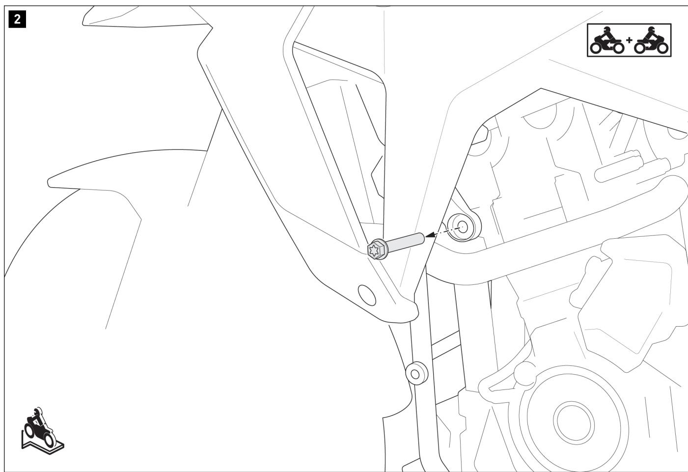
Empuje el revestimiento lateral ligeramente hacia un lado para poder retirar el tornillo original.
