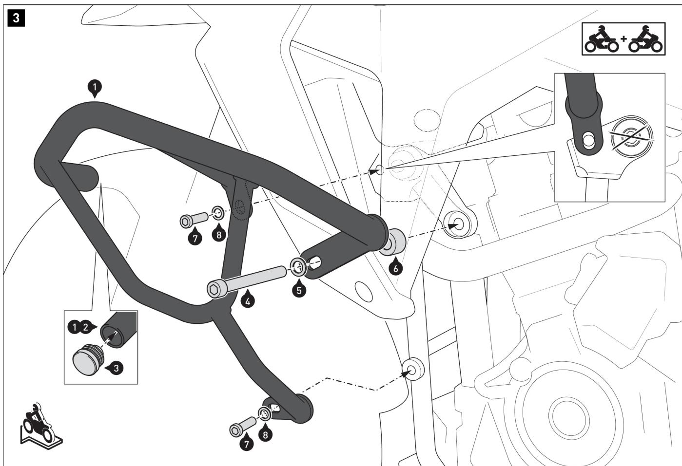
Inserte los tapones de plástico (3) en las aberturas de las protecciones laterales de motor (1/2).
