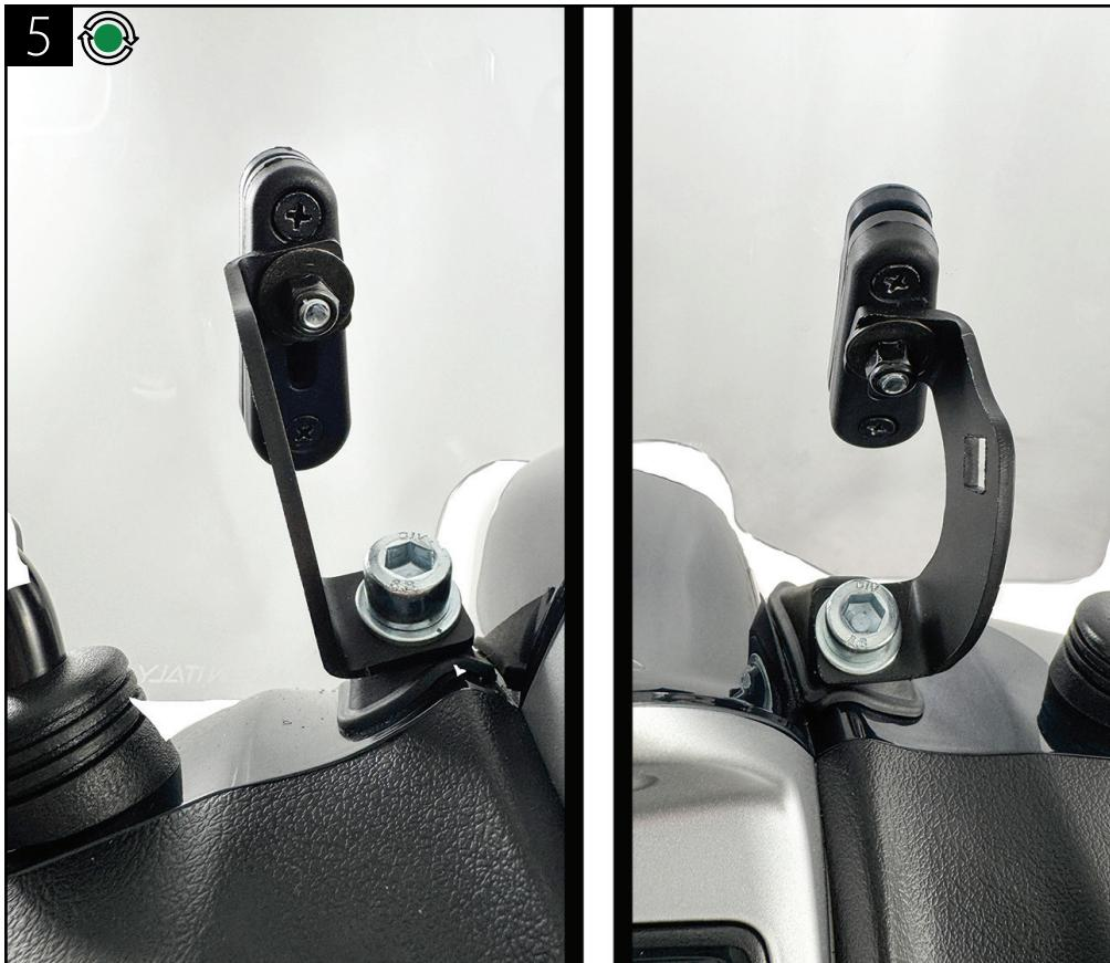
IT / Fissare la lastra, tramite il kit banana precedentemente installato, alle staffe metalliche montate sulla scocca dello scooter, come mostrato in figura.
