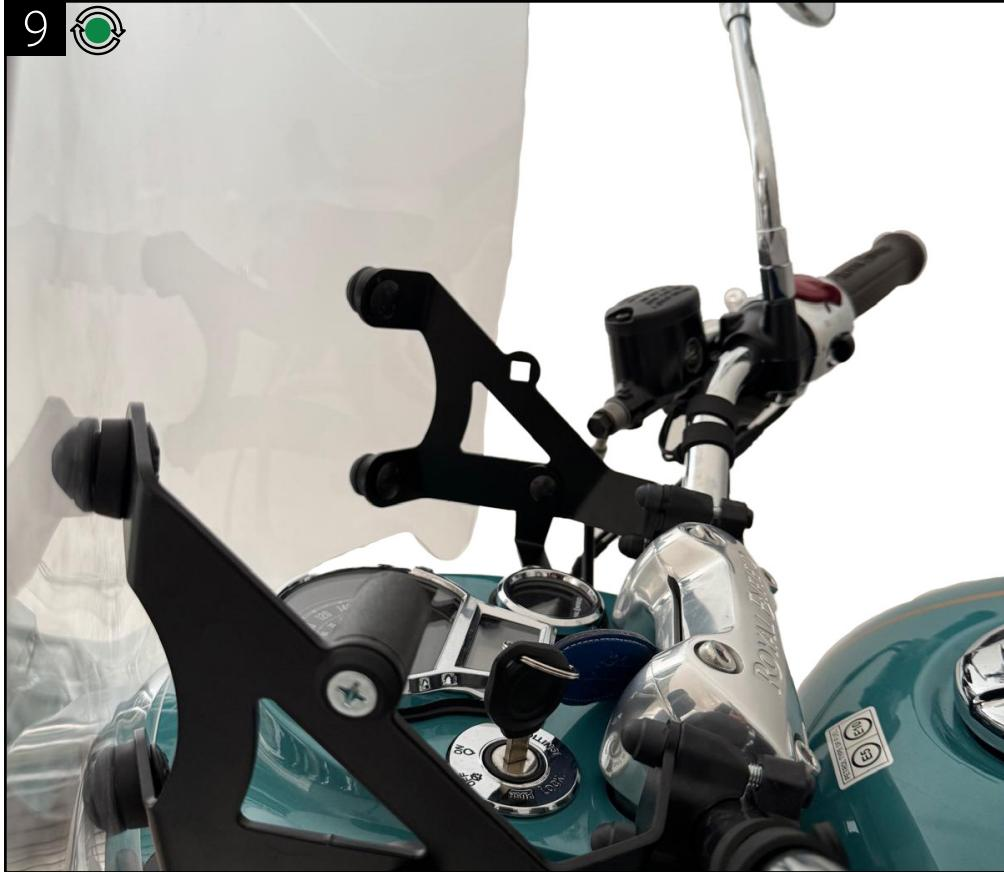
IT / Vista lato guidatore del corretto montaggio delle staffe alla moto e del sistema di sostegno della nostra lastra. A questo punto è possibile procedere al serraggio delle viti per mettere in sicurezza il tutto.
