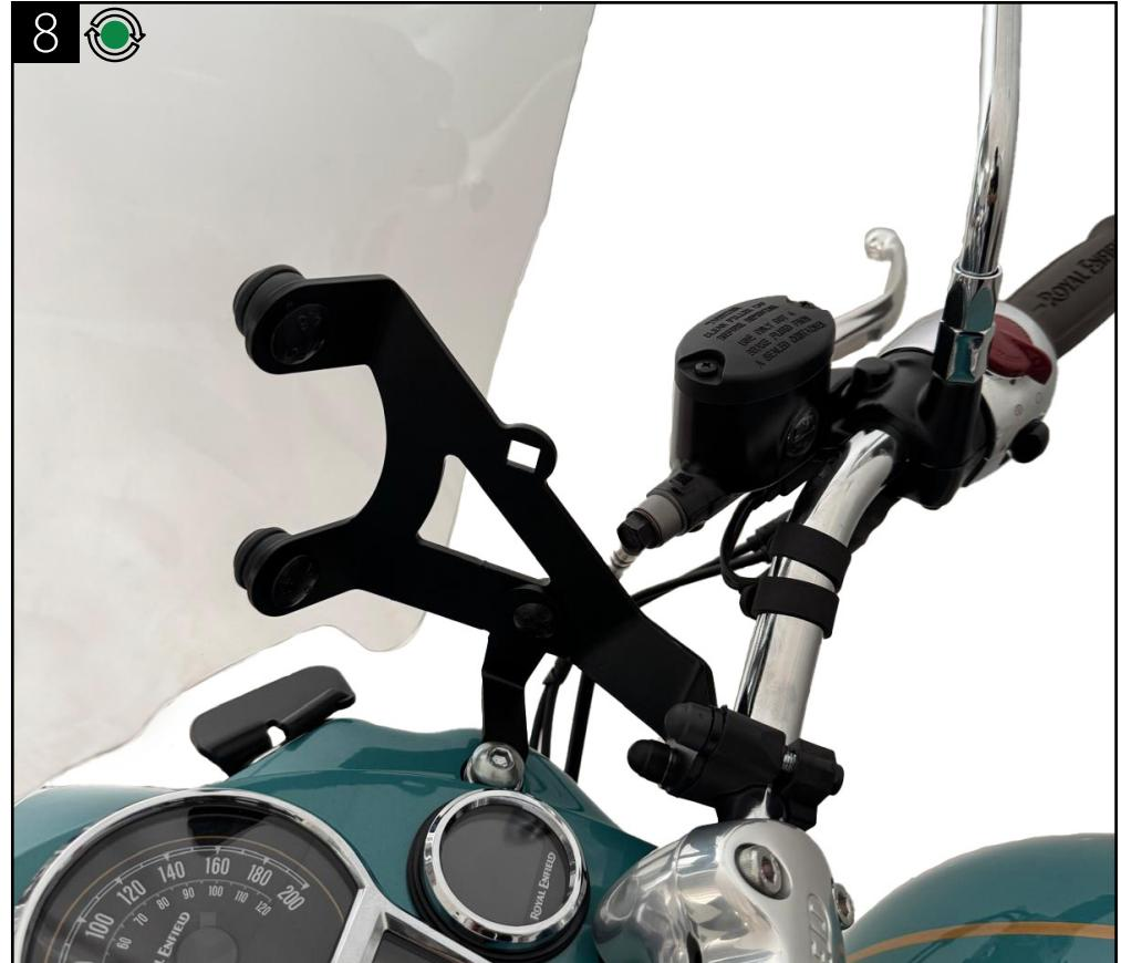
IT / Dettaglio di una staffa correttamente fissata alla moto e alla nostra lastra.
