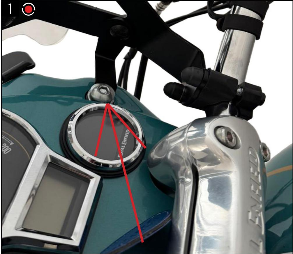
IT / Allentare e rimuovere completamente la vite originale presente sulla forcella, indicata dalla freccia rossa. Conservare il componente, in quanto verrà riutilizzato per il fissaggio della staffa a "L".
