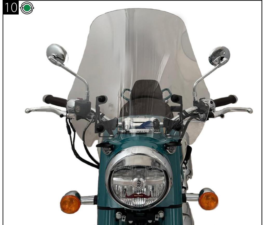
IT / Vista frontale del corretto montaggio della nostra lastra alla moto. Ricordare di serrare correttamente le viti, senza superare i 3 Nm di coppia, per evitare di danneggiarle.
