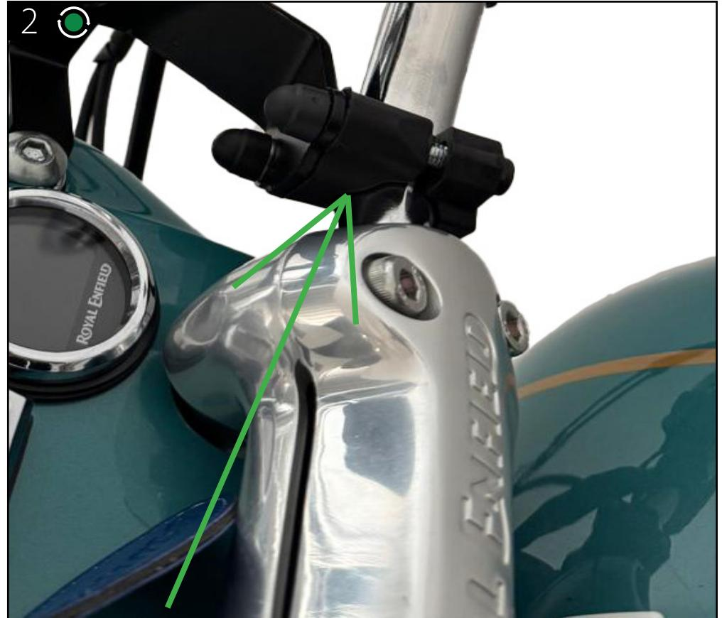
IT / Posizionare il morsetto, indicato dalla freccia verde, sul manubrio senza serrare le viti, in modo da consentirne il posizionamento finale durante il montaggio degli altri componenti e della lastra.
