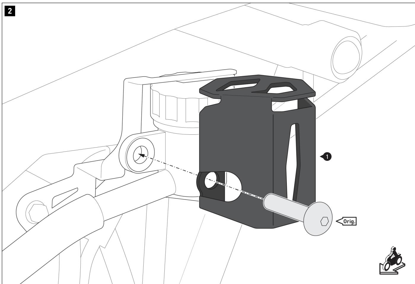
Atornille el protector del depósito de líquido de freno (1) en el depósito de líquido de freno usando el tornillo original.
