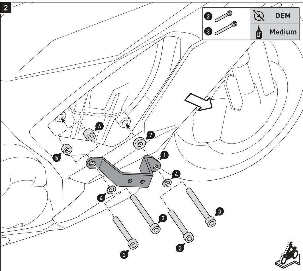
Verschrauben Sie das Anbaublech (1) an der **rechten** Fahrzeugseite. Ziehen Sie dazu die Verkleidungs-teile vorsichtig vom Fahrzeug zurück.
