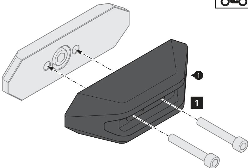
**Schritt [1]:** Verschrauben Sie die Sturzpads (1) beidseitig an den Adapterplatten Ihres SW-MOTECH Sturzpad-Kit, wie in der Anleitung des Sturzpad-Kit beschrieben.
