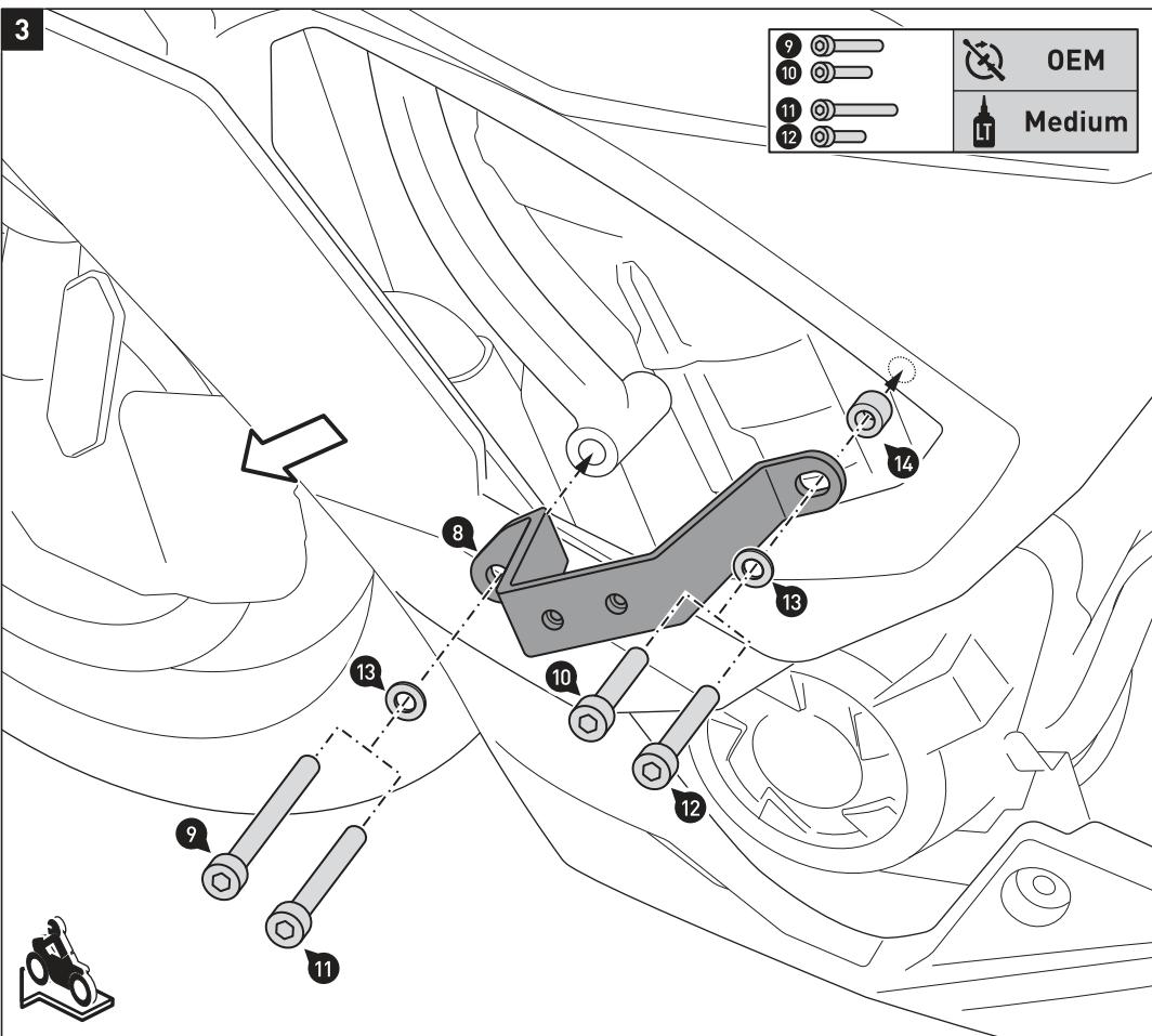
Verschrauben Sie das Anbaublech (8) an der **linken** Fahrzeugseite. Ziehen Sie dazu die Verkleidungssteile vorsichtig vom Fahrzeug zurück.
