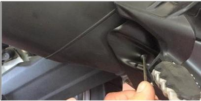
**ITA** Rimuovere i para-calori svitando le viti di sostegno
