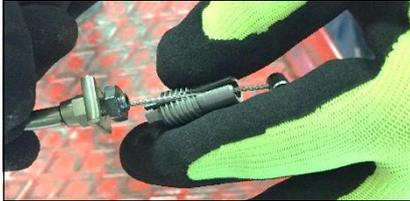
**ITA** Inserire il cavo nella sede e avvitare il corpo regolatore, serrare con chiave da 8 per il corpo regolatore cavo valvola e chiave da 10 per il dado presente sul cavo.
