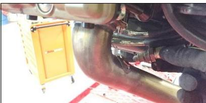
**ITA** Avvitare sonda lambda e infine rimontare i paracoppa.
