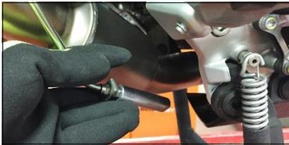
**ITA** Posizionare il regolatore del cavo valvola nel paracoppa.
