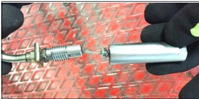
**ITA** Inserire il cavo con il corpo regolatore all'interno della protezione, serrare con chiave da 8 mm per il corpo regolatore cavo valvola e chiave da 13 per la protezione.
