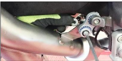
**ITA** Avvitare la staffa del collettore con la vite e rondella di serie, e con dado autobloccante e rondella in dotazione posizionati dietro come in foto
