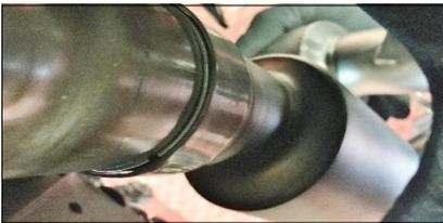
**ITA** Iniziare a posizionare il collettore inserendolo nell'attacco testa orizzontale di serie
