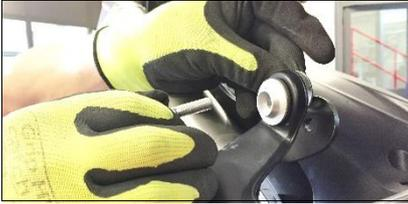
**ITA** Avvitare la staffa supporto la rondella tra il telaio e la staffa e il dado dietro la staffa. silenziatore al telaio usando la vite, la rondella e il dado di serie, posizionando
