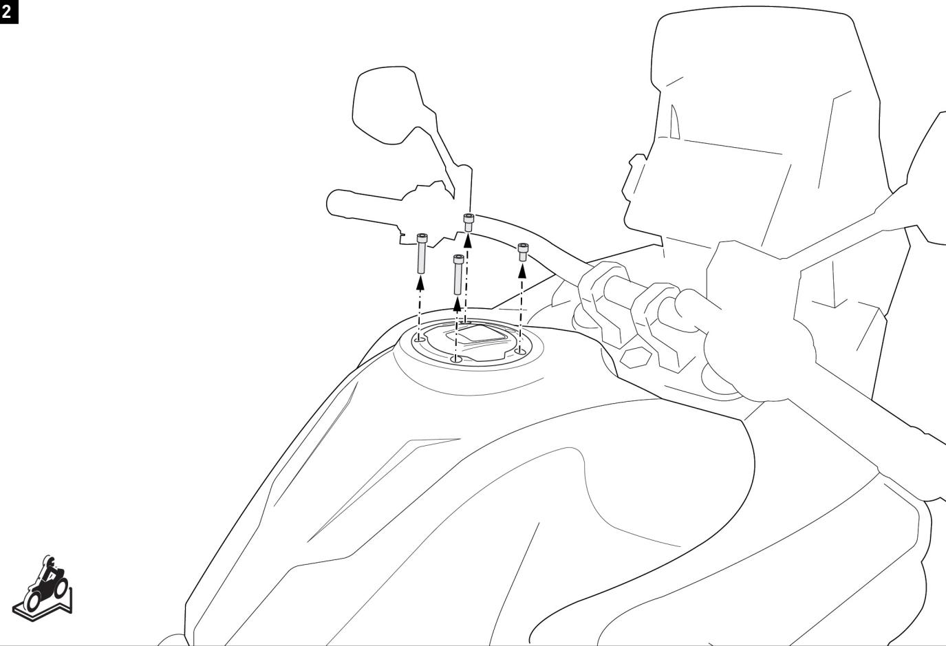
Retire los tornillos originales de los puntos de fijación indicados.
