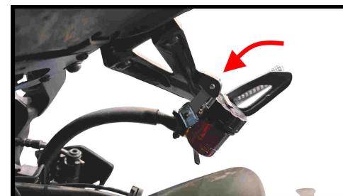
Posizionare la staffa in dotazione sulla pedana come mostrato. Serrare solo dopo aver riposizionato la vaschetta. Position the supplied bracket on the footrest as shown. Tighten only after replacing the tray.
