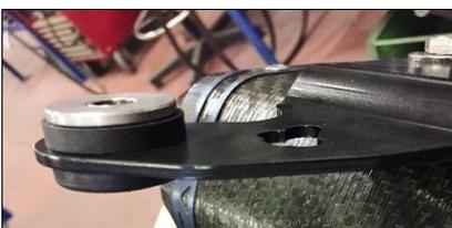
**ITA** Assemblare il distanziale e il silent-block sulla staffa di supporto (in dotazione) aggiungendo il silent-block maschio (13)
