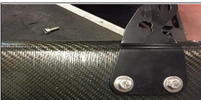
**ITA** Montare la staffa supporto silenziatore (10) con le viti M8x25 (23) e rondelle 8x24 (11) in dotazione;
