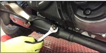
**ITA** Svitare e rimuovere la sonda completamente
